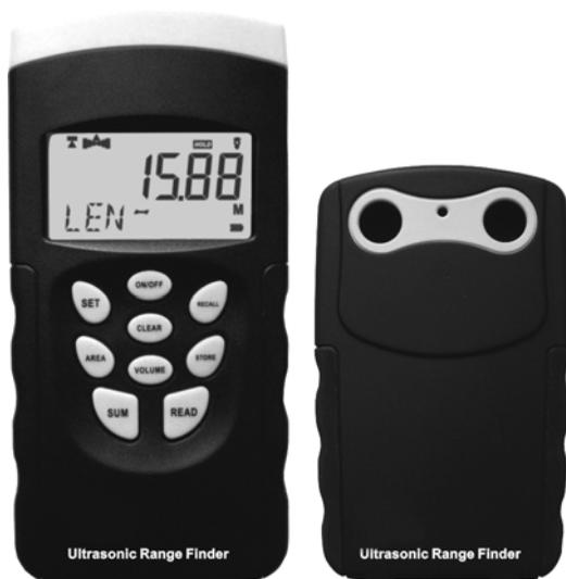
Ультразвуковой дальномер AR851 предназначен для измерения расстояний до объектов в закрытых помещениях в пределах от 0,5м до 20м (с приставкой: от 1м до 60м) под прямым углом и вычисления сумм расстояний, площади и объема.
